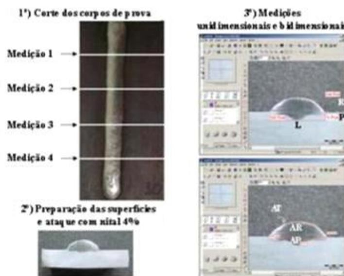
Figura 2 - Procedimento para medição da geometria do cordão de solda.
